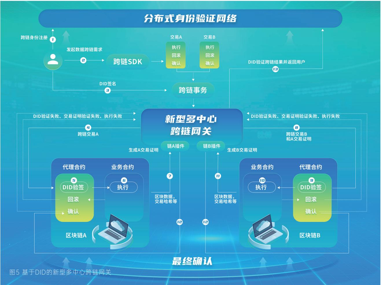
图5 基于DID的新型多中心跨链网关
